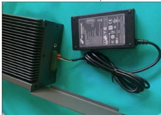
Ensuite, insérez le câble d'alimentation CA (fourni) dans le bloc d'alimentation et branchez l'autre extrémité dans une prise CA.
