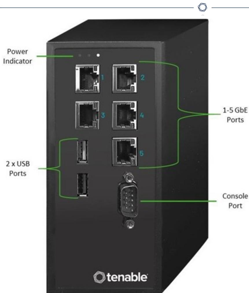
**Remarque :** ce modèle peut être monté soit sur un rail DIN, soit sur un rack de montage (à l'aide du kit d'adaptateur). Par le passé, ce modèle était appelé Capteur pour rail DIN.
