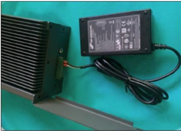
Ensuite, insérez le câble d'alimentation CA (fourni) dans le bloc d'alimentation et branchez l'autre extrémité dans une prise CA.
