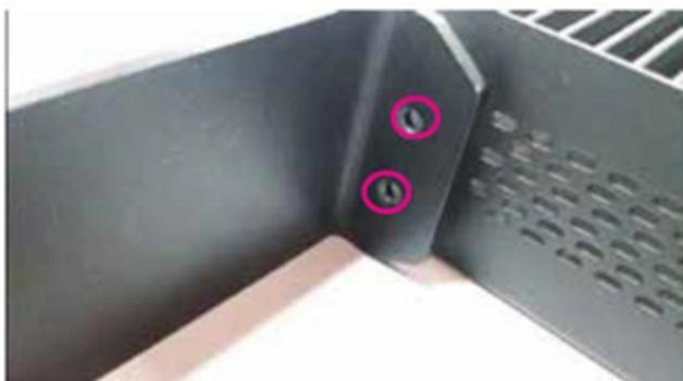
2. Insérez deux vis de chaque côté et fixez-les avec un tournevis pour maintenir les supports en place.
